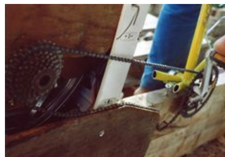
La chaîne en position lavage / rinçage
