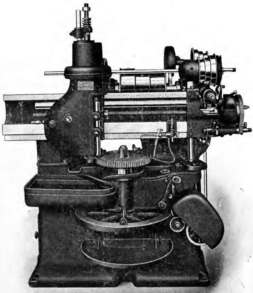
FELLOWS GEAR SHAPER CUTTING SPUR GEAR
