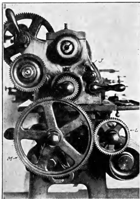
Fig. 164. Simple Lathe Gearing
