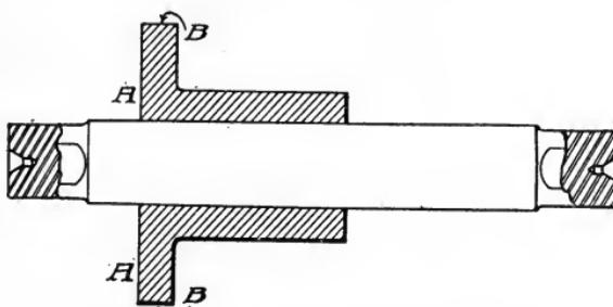
Fig. 110. Stuffing-Box Gland Held on Mandrel
