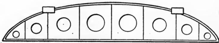
Fig. 3. Cast-Iron Straightedge
