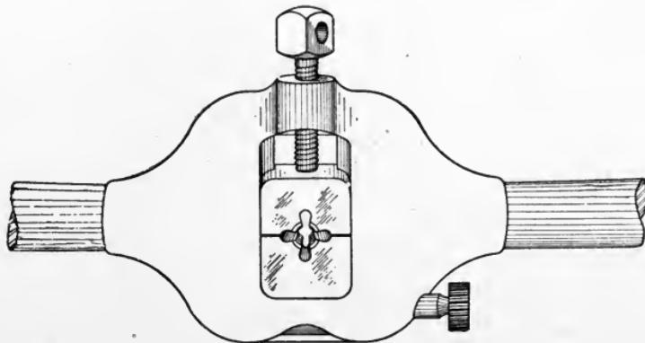
Fig. 85. Threading Die Holder
