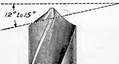
Fig. 71. Cutting Edge Clearance
