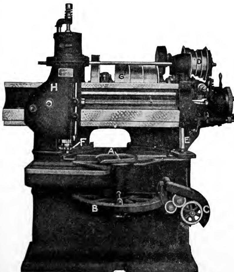
Fig. 288. Gear Shaper
