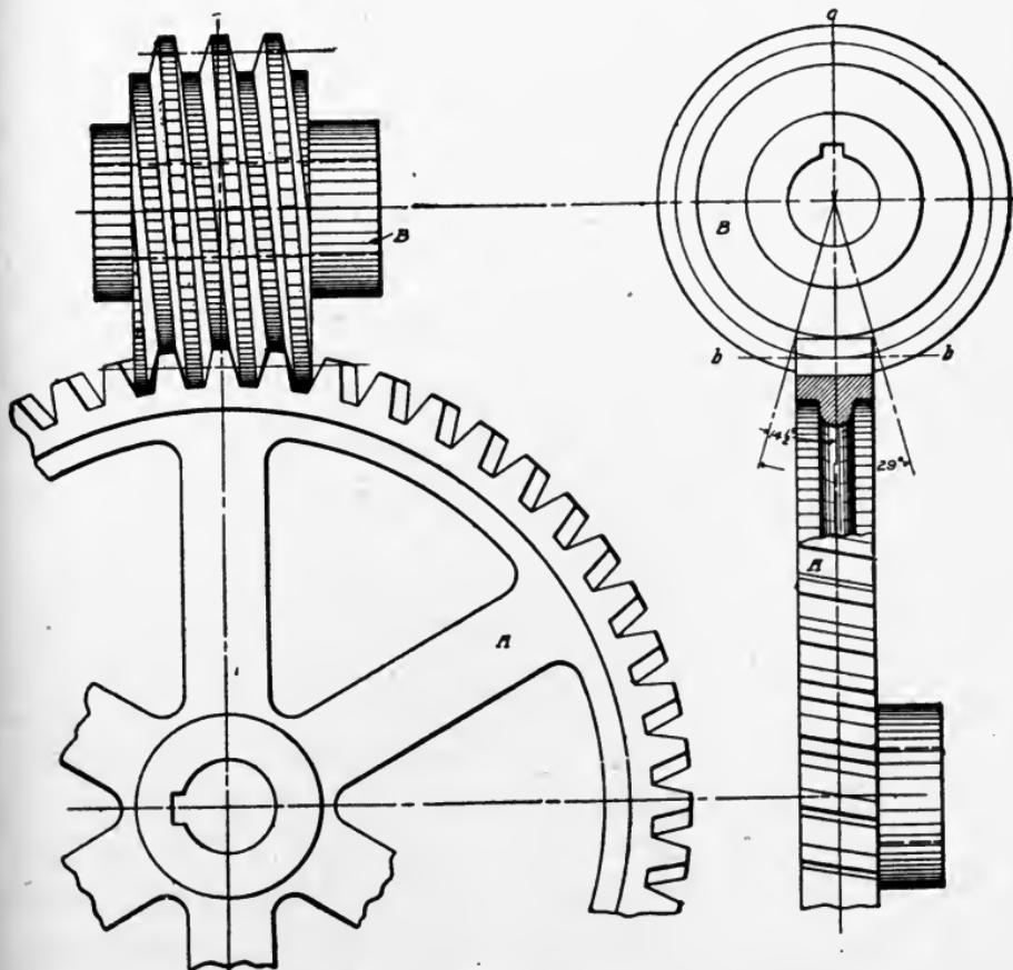
Fig. 272. Simple Worm Gear
