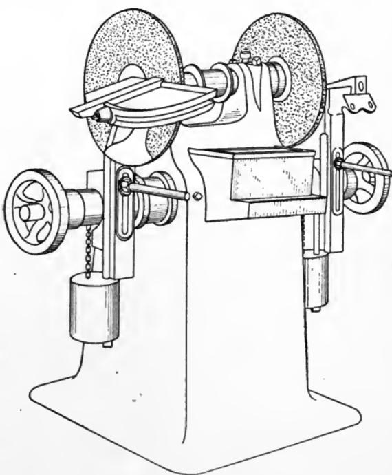
Fig. 249. Disc Grinder
