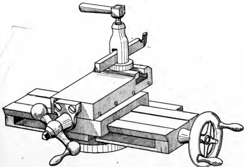
Fig. 94. Hand Lathe Slide Rest
