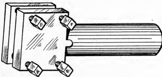
Fig. 305. Simple Tool Clamp
